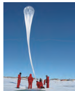
2003年に南極昭和基地で行われた直径32m、高さ6μmの大気球によるオゾンホール観測。2種類の測定器をつないで地上から高さ40kmまでのオゾン濃度を高解像度で測る。定期的に行われているゴム気球観測と比べると大がかりだが、より高い高度まで観測できて、オゾン層全体をとらえられるのが特徴だ。(写真右端が佐藤薫)
