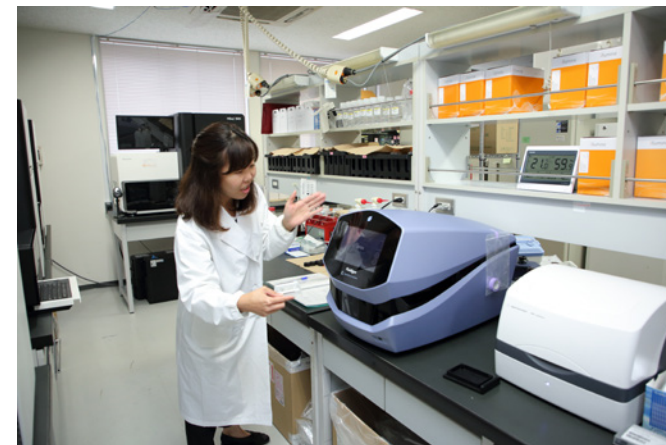
細胞ひとつひとつを選り分けて読み取る、シングルセル分離解析機。
